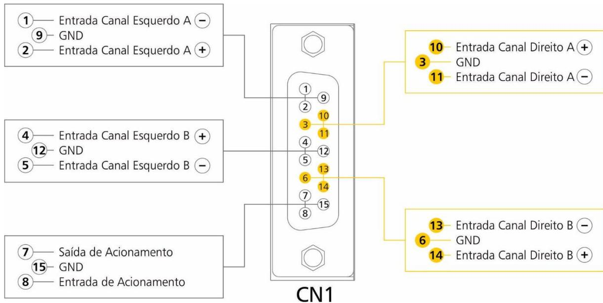
Figura 12: Pinos de conexão - DB15.
