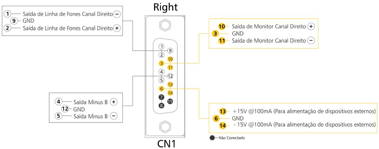
Figura 27: Conexão no DB15 - Right.
