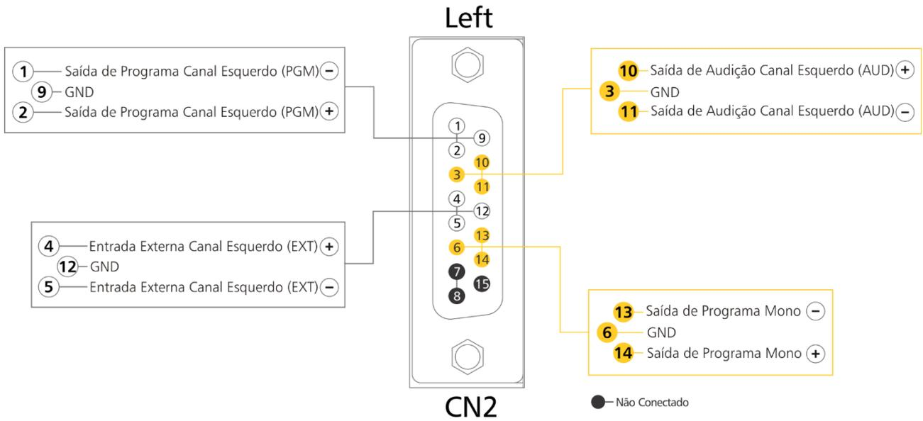
Figura 23: Conexão no DB15 - Left.
