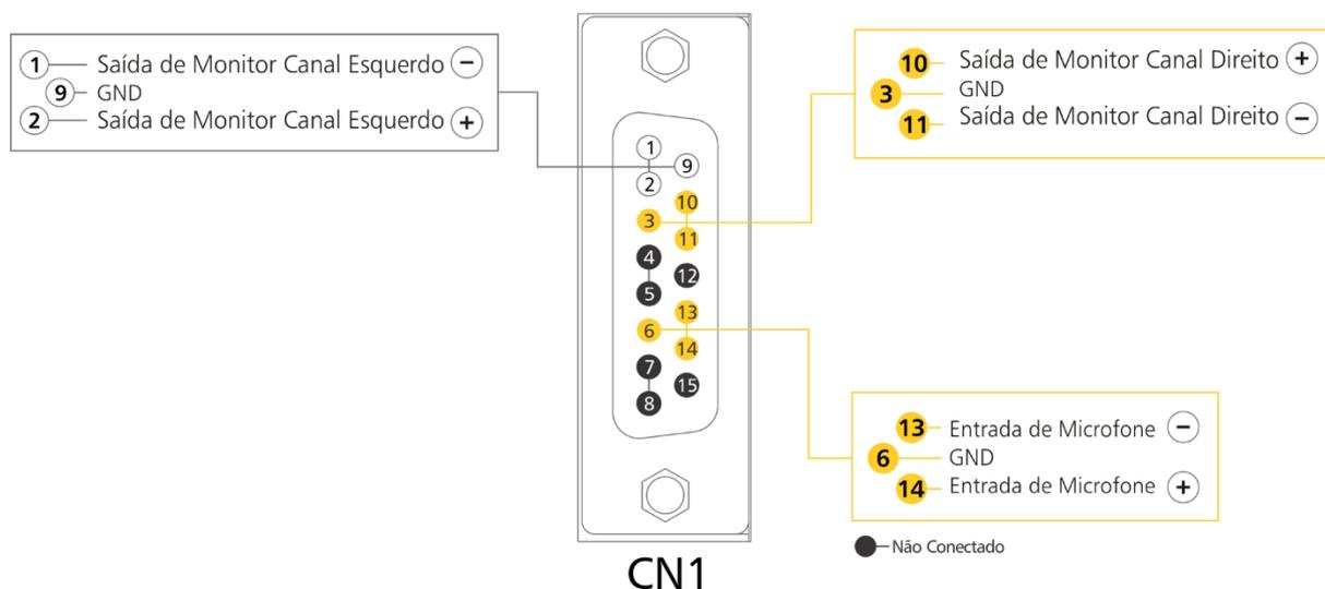
Figura 30: Conexão no DB15.
