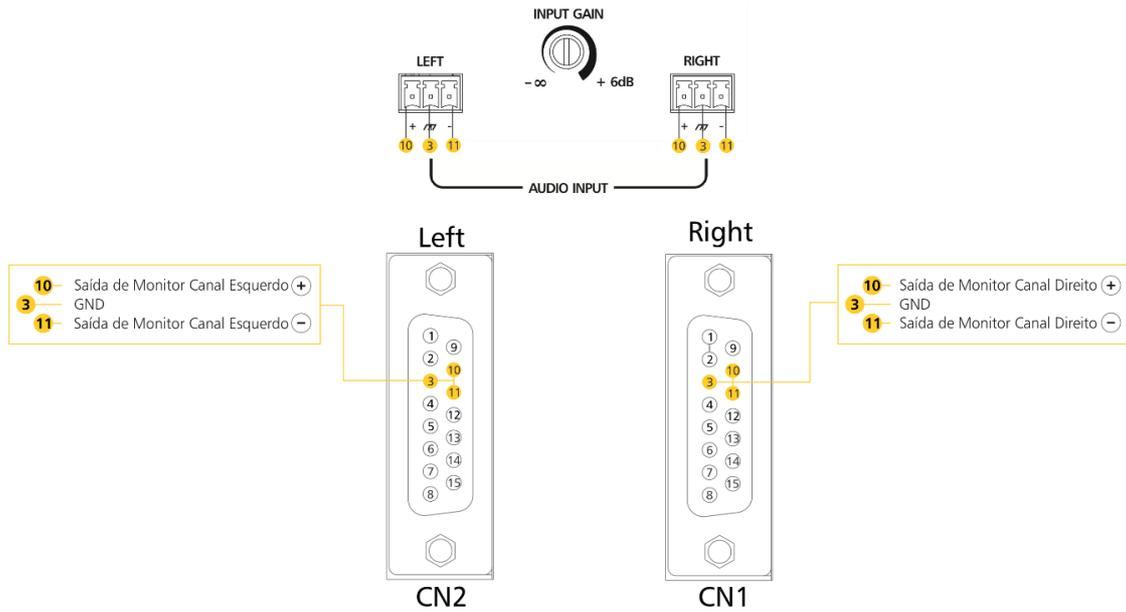
Figura 28: Conexão com a entrada do amplificador de áudio.
