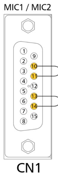
Figura 18: Curto nos pinos quando não é utilizado o processador de microfone.
