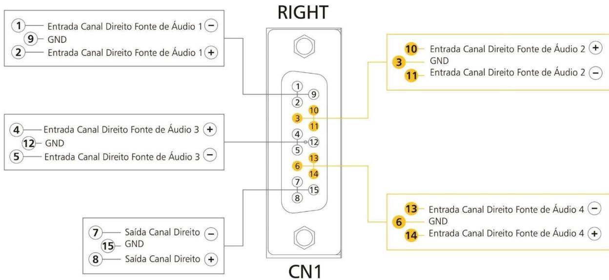
Figura 33: Conexão no DB15 - Right.
