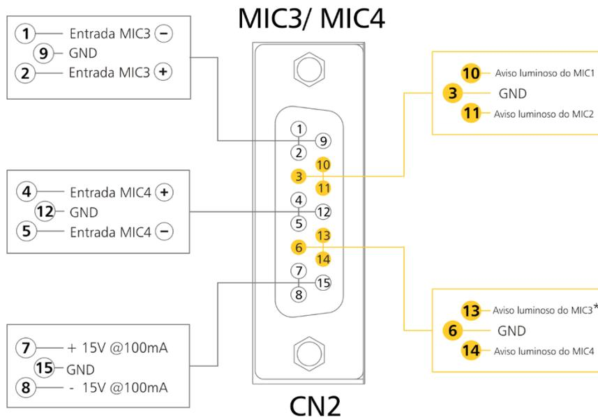
Figura 16: Pinos de conexão - DB15.
