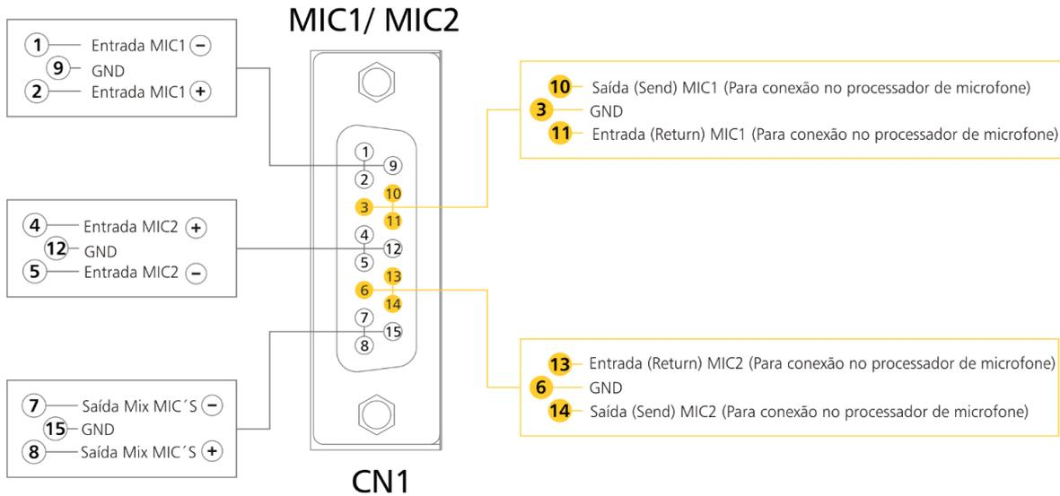
Figura 15: Pinos de conexão - DB15.
