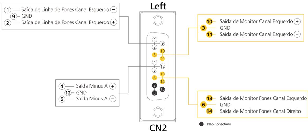
Figura 26: Conexão no DB15 - Left.
