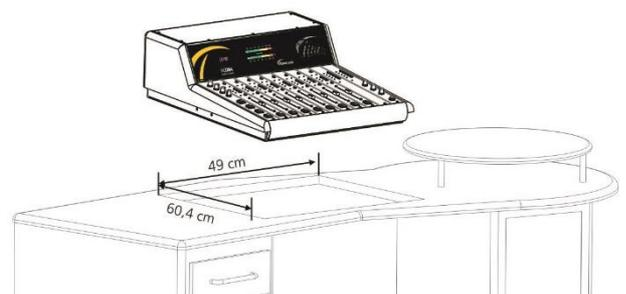
Figura 2: Madeira lateral com corte para encaixe no mobiliário.
