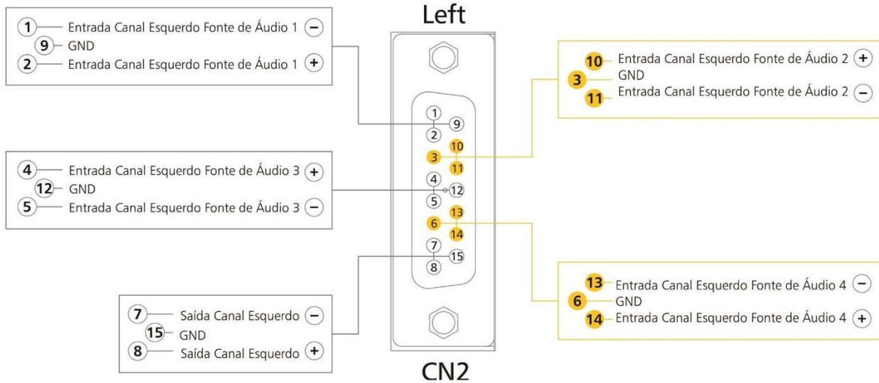
Figura 32: Conexão no DB15 - Left.
