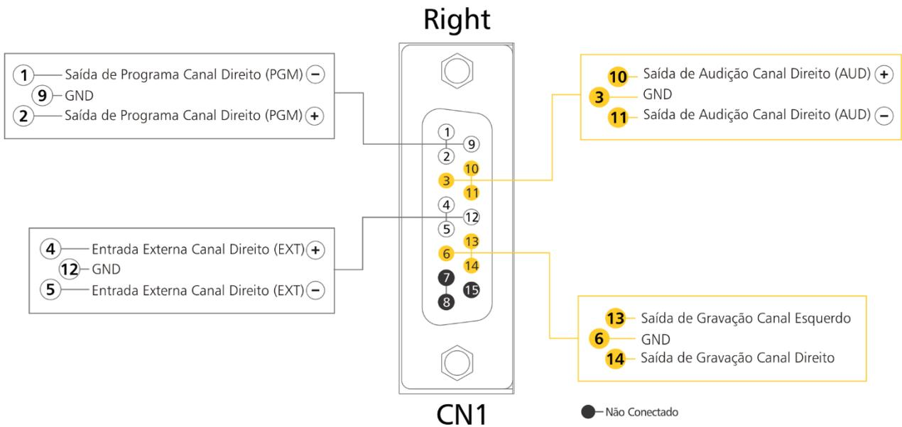
Figura 24: Conexão no DB15 - Right.
