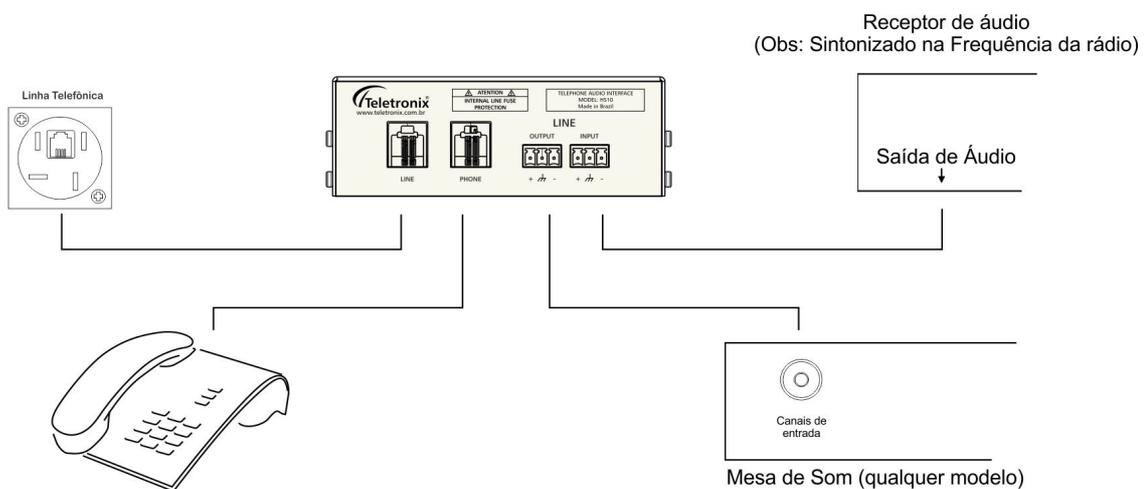
Figura 3: Sistema em rádio com qualquer tipo de mesa de som (este sistema elimina o risco de microfonia)
