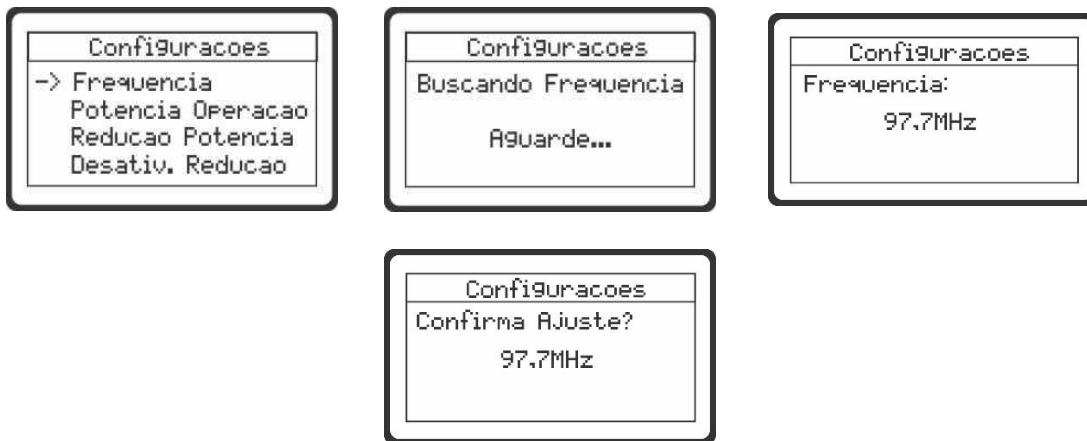
A alteração da frequência só será possível mediante a remoção de um Jumper previsto em um dos circuitos internos do transmissor. Após retirar, o equipamento disponibiliza o menu frequência para ser configurado. (Mais informações sobre este Jumper, item 7.4).
