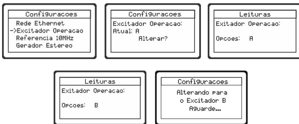
**Obs:** Condições automáticas para alteração do excitador A para B ou de B para A.
