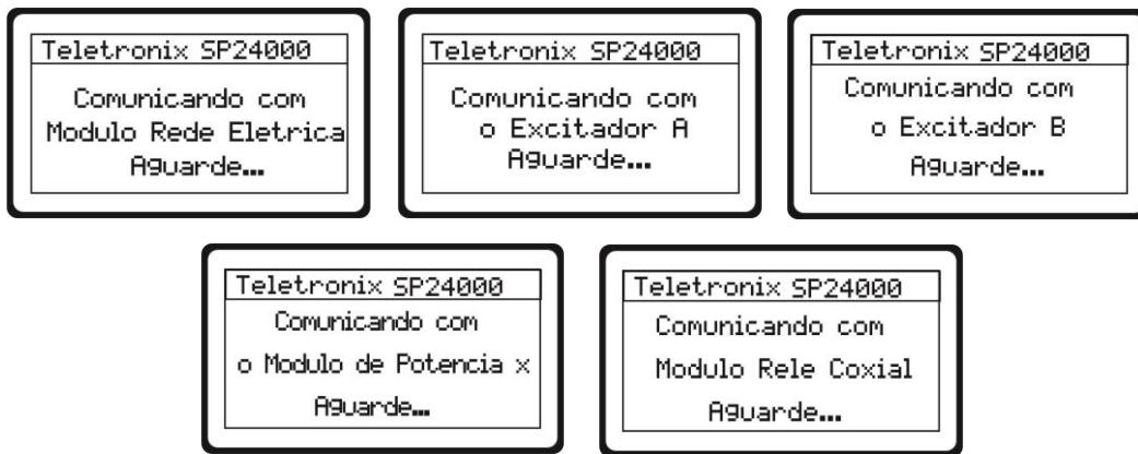
**Obs:** Na tela “Comunicando com o módulo de potência x Aguarde...” o x refere-se aos módulos de 1 a 8.
