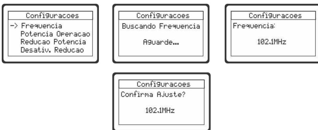
A alteração do canal só será possível mediante a colocação de um Jumper previsto em um dos circuitos internos do transmissor. Após a inserção, o equipamento disponibiliza o menu Canal para ser configurado. (Mais informações sobre este Jumper, item 3.6.
