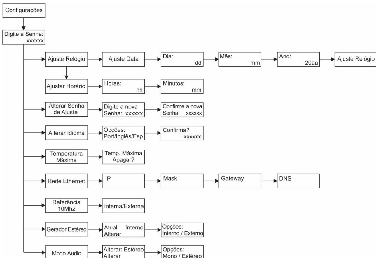
Fluxograma 2: Modo configuração de fabrica
