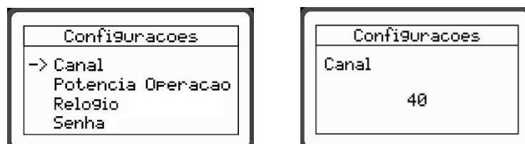
**Observação:** A alteração do canal só será possível mediante a remoção de um Jumper previsto em um dos circuitos internos do transmissor. Após a remoção, o equipamento disponibiliza o menu Canal para ser configurado. (Mais informações sobre este Jumper, item 3.5).
