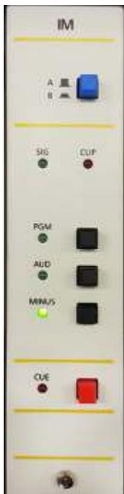
Qualquer Conector da Régua IM (Input Module/Módulo de Entrada) para entrada da Chave Híbrida.
