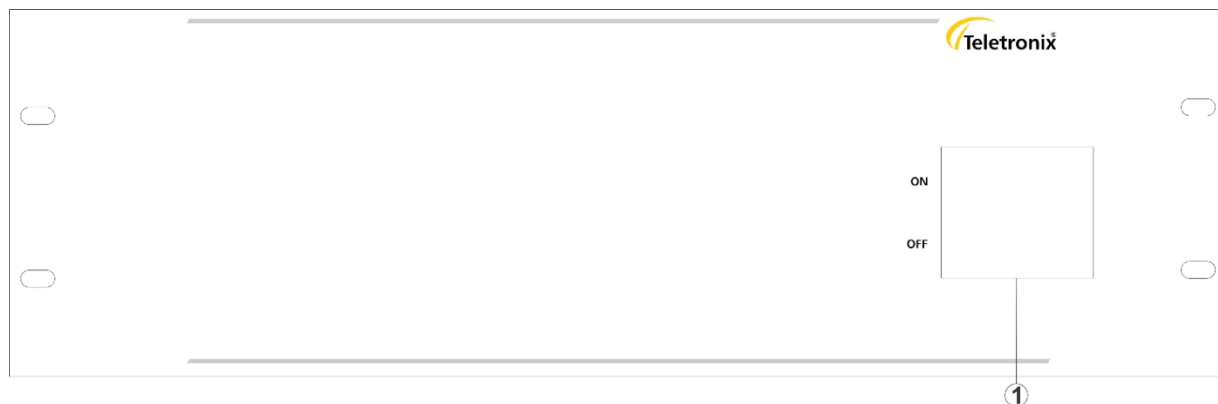
Figura 7: Painel frontal da carga inferior e disjuntor.
