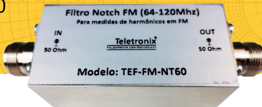
O Filtro Notch da Teletronix modelo TEF-FM-NT60 foi projetado para uso em medidas de segundo Harmônico em Transmissores de FM ele é um filtro do Tipo rejeita faixa onde compreende toda a faixa estendida começando em 76 Mhz até a freqüência final de 108 Mhz.
