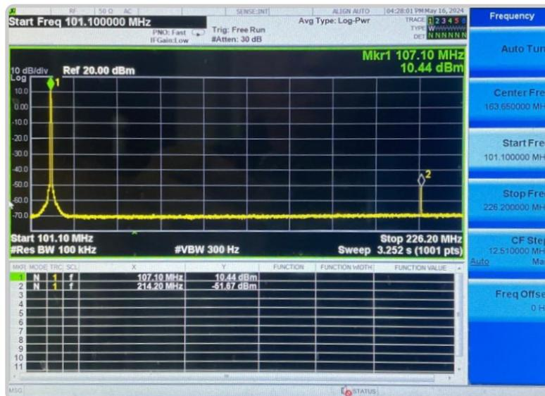
Para medir o sinal da portadora fundamental, mova o cursor do espectro até que esteja alinhado com o pico da portadora fundamental e efetue a medição. Neste caso, a medição resulta em um nível de **+10,44 dBm**.
