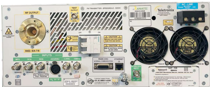
Slot OPGR-RDS-PRO.02 O Opcional Processador Digital e Gerador de RDS Fica neste local que está esta Placa de Homologação.
