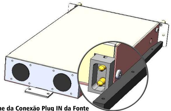
Detalhe da Conexão Plug IN da Fonte
